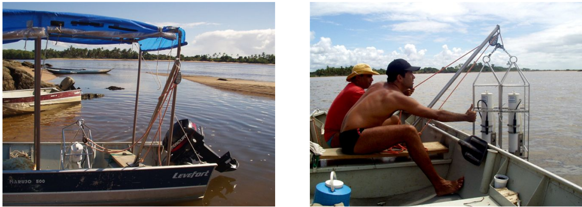
Figura 5.5. Estrutura para o CTD, à esquerda, com suporte de madeira/metal + haste e roldana, e operação do equipamento (direita).
