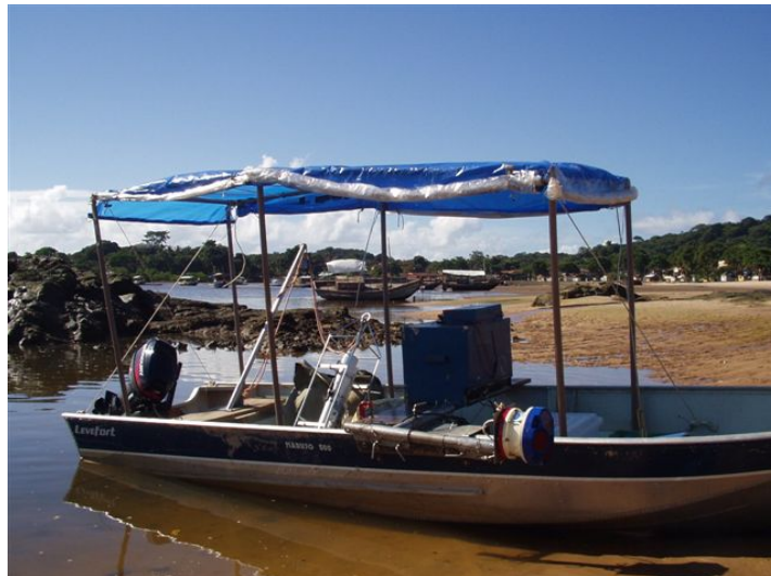
Figura 5.8. Barco equipado para o monitoramento de seção transversal com ADCP e CTD.
