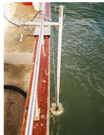
Figura 5.9. Estrutura de fixação do ADCP adaptada à embarcação de alumínio de 5 m (esquerda) e ao barco da FUNDIPESCA com 15 m de comprimento (direita).
